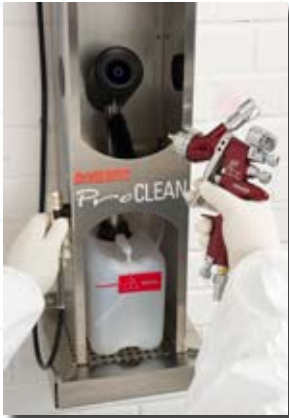
Usunąć kubek lakierniczy i podłączyć pistolet do przewodu powietrza.
