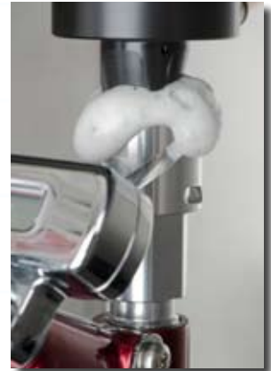
... trzymając wciśnięty spust pistoletu umożliwiamy dokładne wyczyszczenie pistoletu. Powtórzyć.
