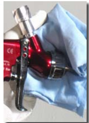
Przetrzeć głowicę czystą szmatką, a następnie pistolet będzie gotowy do użytku.
