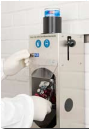
Nacisnąć przycisk powietrzny by przedmuchać i osuszyć pistolet.
