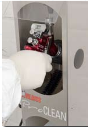
Umieścić pistolet w gnieździe dla głowicy i naciskać spust przez 3-4 sekundy.
